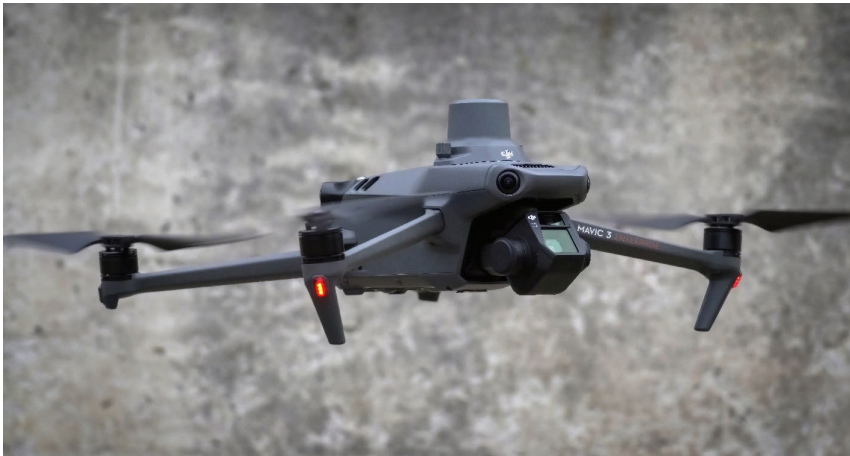
Abb. 06: Das unbemannte Luftfahrtsystem (UAS) kennt dank RTK-Modul seine exakte Position zentimetergenau. [Foto: F7 DIGITAL GmbH]
