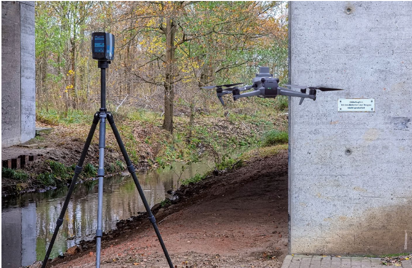
Abb. 01: Der 3D-Laserscanner und die Vermessungsdrohne als Werkzeuge vor Ort im Einsatz [Foto: F7 DIGITAL GmbH]
