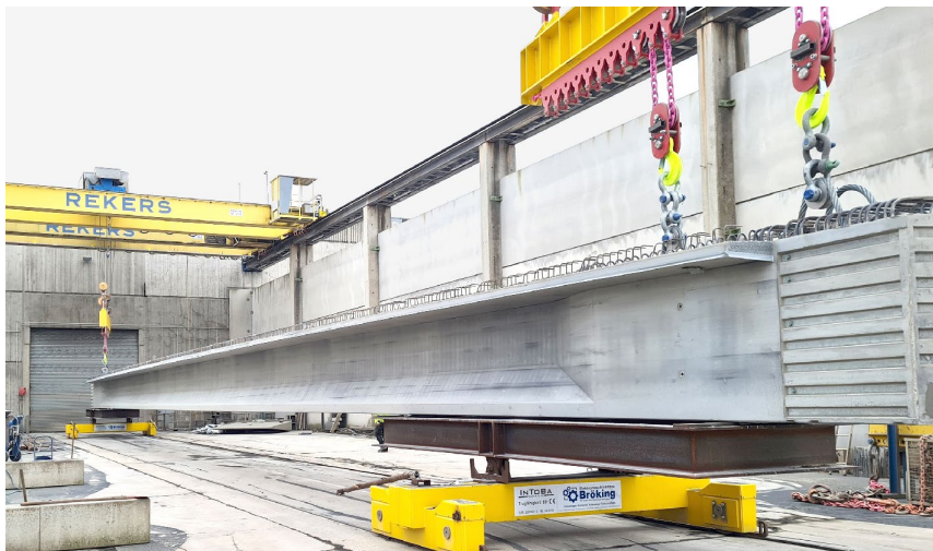
Abb. 08: Ausbau der Fertigteilträger nach Herstellung im Fertigteilwerk [Quelle: KHP Dortmund]
