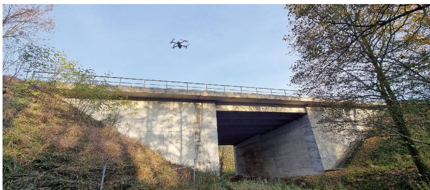
Abb. 03: Das fliegende Vermessungssystem erstellt 3D-Messpunktvolken aus 2D-Fotodaten. [Foto: F7 DIGITAL GmbH]
